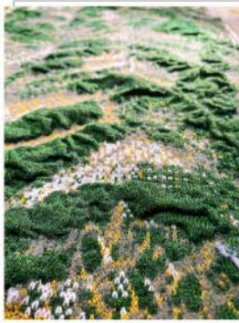
Makine: 14gg shima selki SSR Üretim yöntemi: Jakarlı örme Örgü yapısı: Pike jakar ve Blister (torba örgü ) İplik: 20/2 % 50 Pamuk/ Akrilik ( Spicy Mustard) 20/2 % 50 Pamuk/ Akrilik ( Cocoonat Milk) 20/2 % 50 Pamuk/ Akrilik ( Dark green olive ,yansımalı) 18Nm %100 PA,sakallı (pevter)
